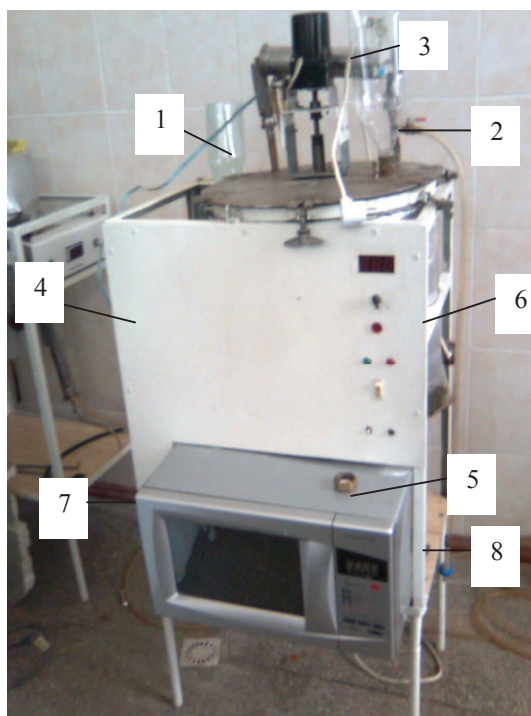
1 – штуцер з смістю для наповнення екстрактора розчинником; 2 – штуцер з смістю для наповнення реакційного об'єму твердою фазою; 3 – зворотний холодильник; 4 – екстрактор; 5 – електромагнітний інтенсифікатор; 6 – датчик для вимірювання температури проміжного теплоносія; 7 – датчик для вимірювання температури продукту на вході в MXI; 8 – датчик для вимірювання температури продукту на виході з MXI.
