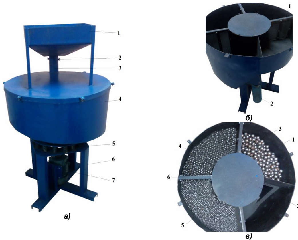
Рис. 4. Конструкція вібраційного торovidного млина: а) 1 – завантажувальний бункер; 2 – регулююча заслінка; 3 – живильна горловина; 4 – торovidний контейнер; 5 – пружинні елементи; 6 – станина; 7 – електродвигун; б) 1 – ситові елементи; 2 – вивантажувальний патрубок; в) 1 – контейнер; 2 – внутрішній циліндр для вібропривода; 3 – фракція 12 мм; 4 – фракція 8 мм; 5 – фракція 1 мм; 6 – ситові фіксатори
