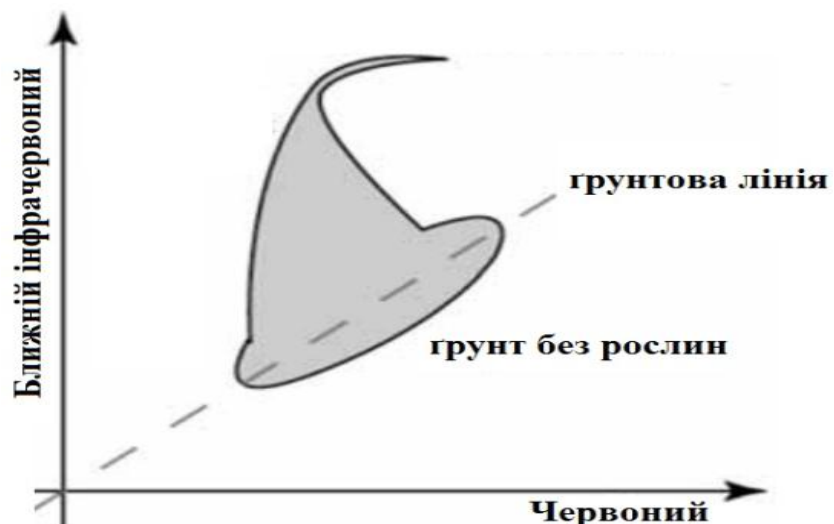
Рис. 2. Типовий розподіл значень відображення для сільськогосподарських культур в червоному і ближньому інфрачервоному каналах
