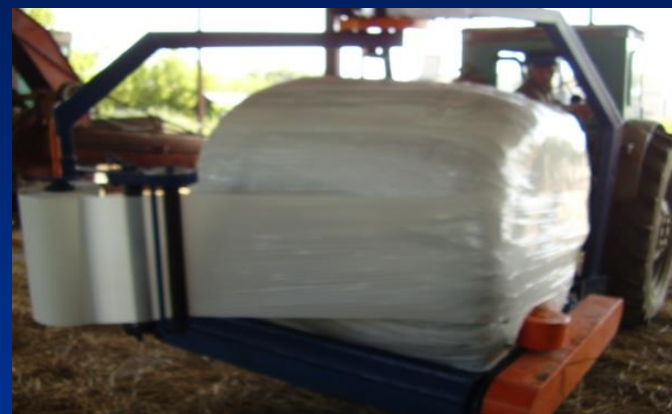
Герметизація рулону сінажу з люцерни вітчизняним обмотувальником ОР-1
