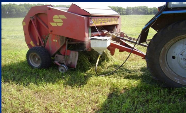
Підбір маси з валку прес-підбирачем з одночасним внесенням мінерального консерванту
