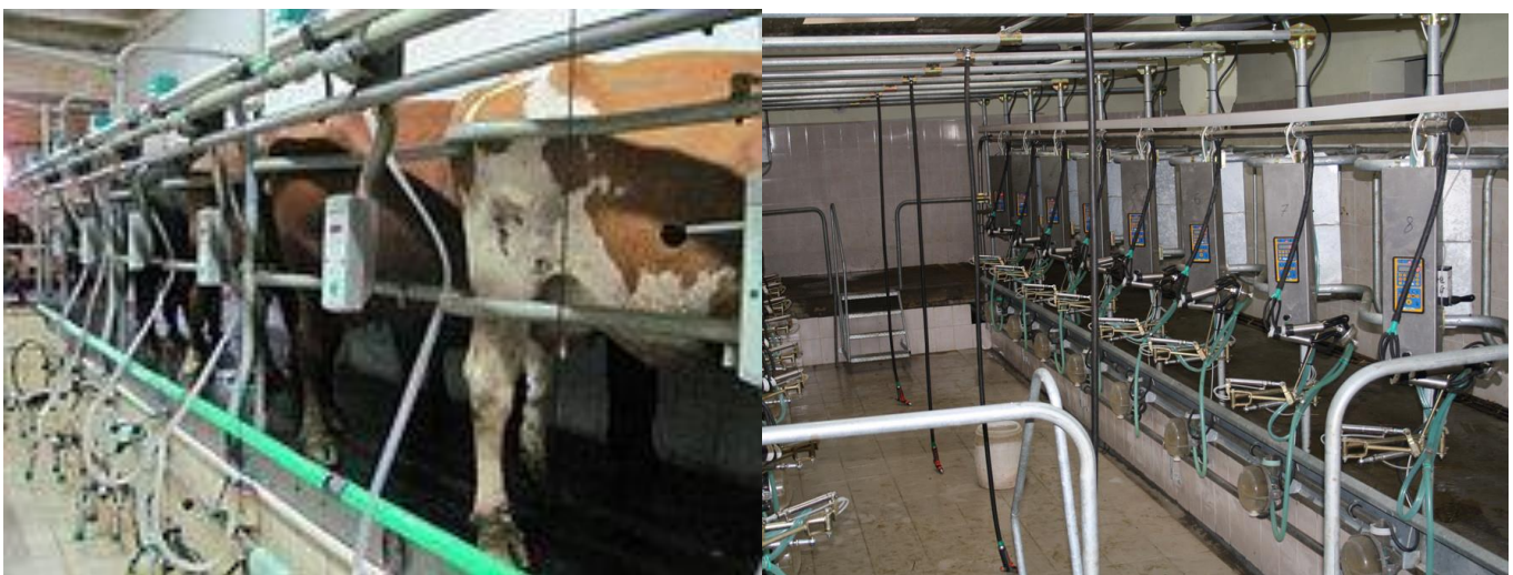
Рис. 2.15. Доїльний зал Ялинка
