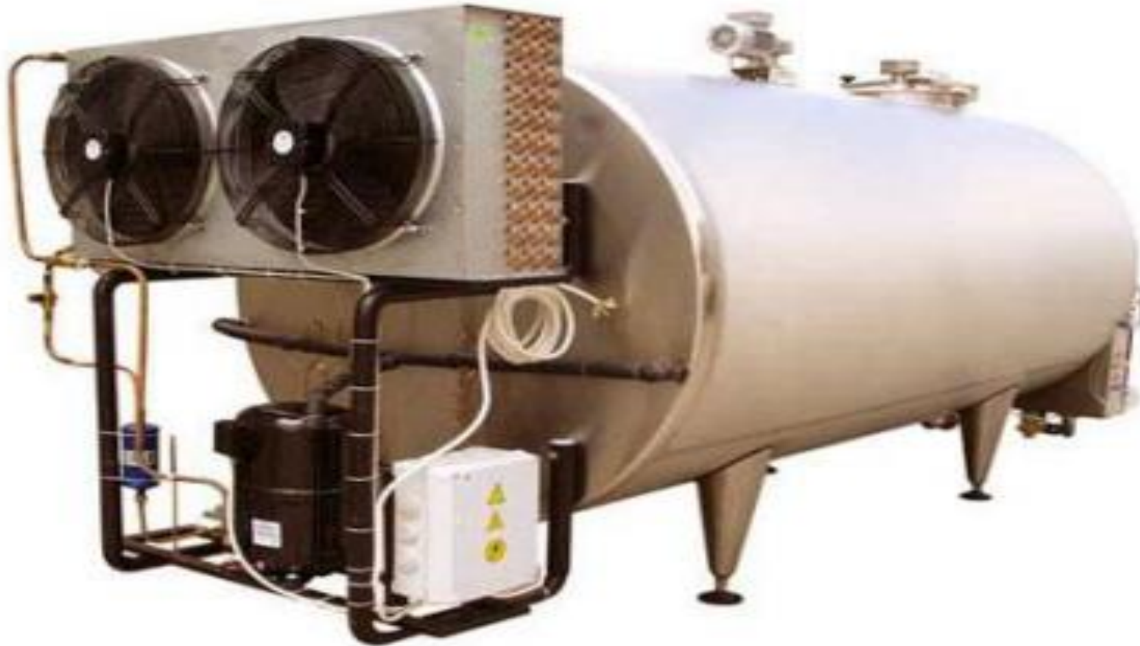
Горизонтальний танк-охолоджувач молока безпосереднього охолодження закритого типу
