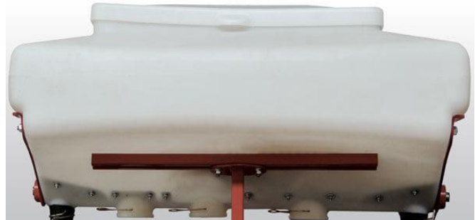
Рис. 10. Бункер для добрив сівалок VESTA 6 PROFIL і VEGA PROFIL об'ємом 170 л.
