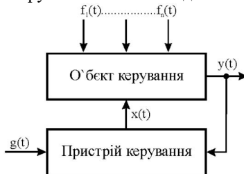
Рисунок 10 - Структура САК, побудованої на основі принципу керування за відхиленням
