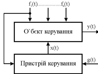
Рисунок 8 - Структура САК, що побудована на основі принципу керування за збуренням
