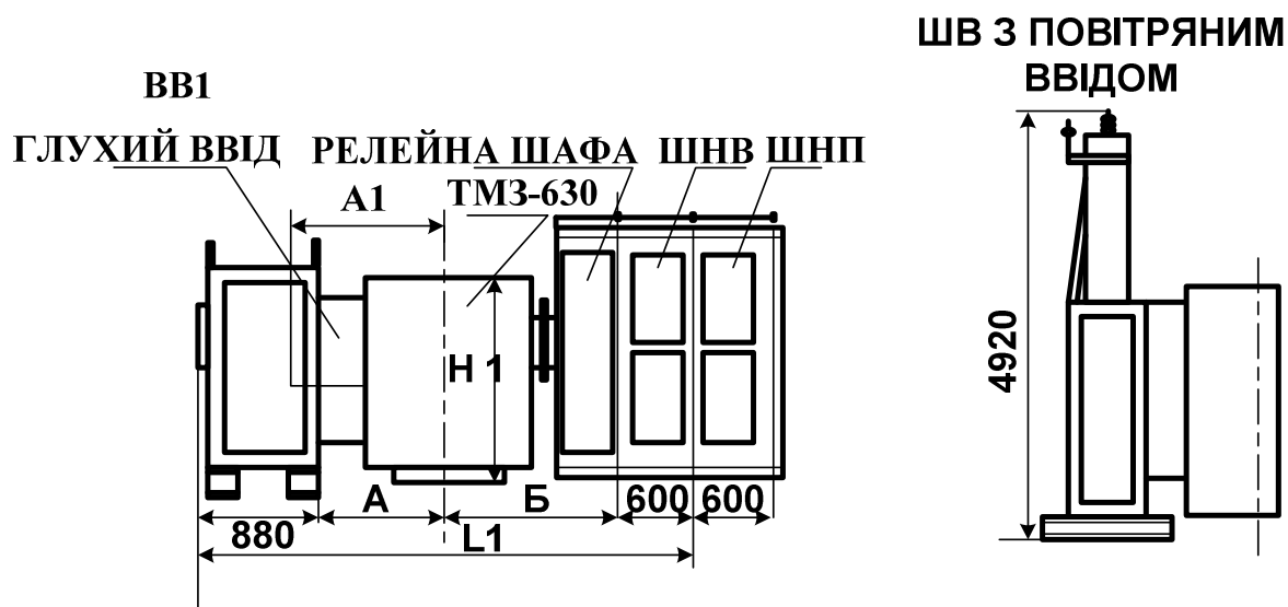
Рисунок 7.13 – Конструктивне виконання KTP зовнішнього встановлення
