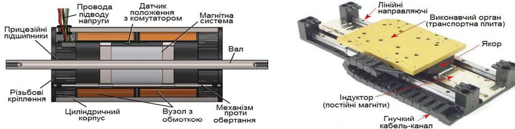
Рисунок 6.4 – Лінійний двигун і основні елементи
