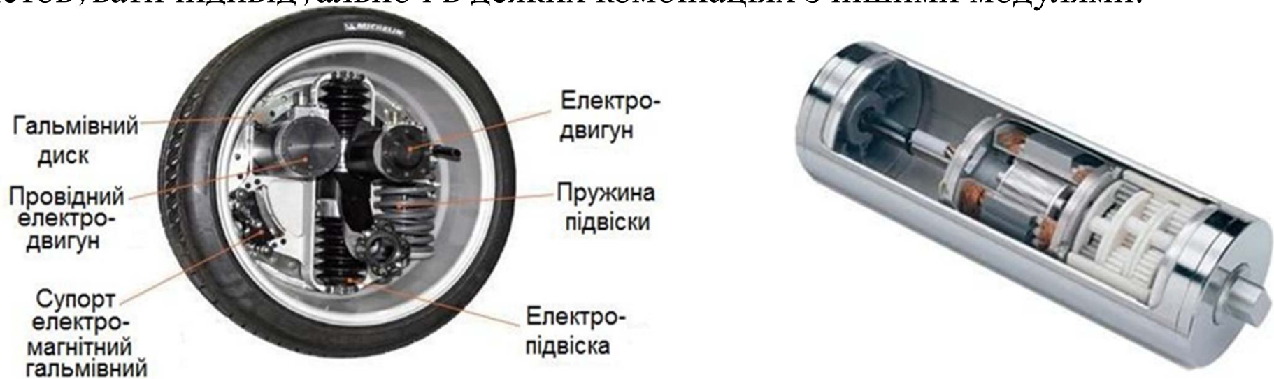
Рисунок 1.2 – Модулі руху: мотор-колесо (а), мотор-барабан (б)
