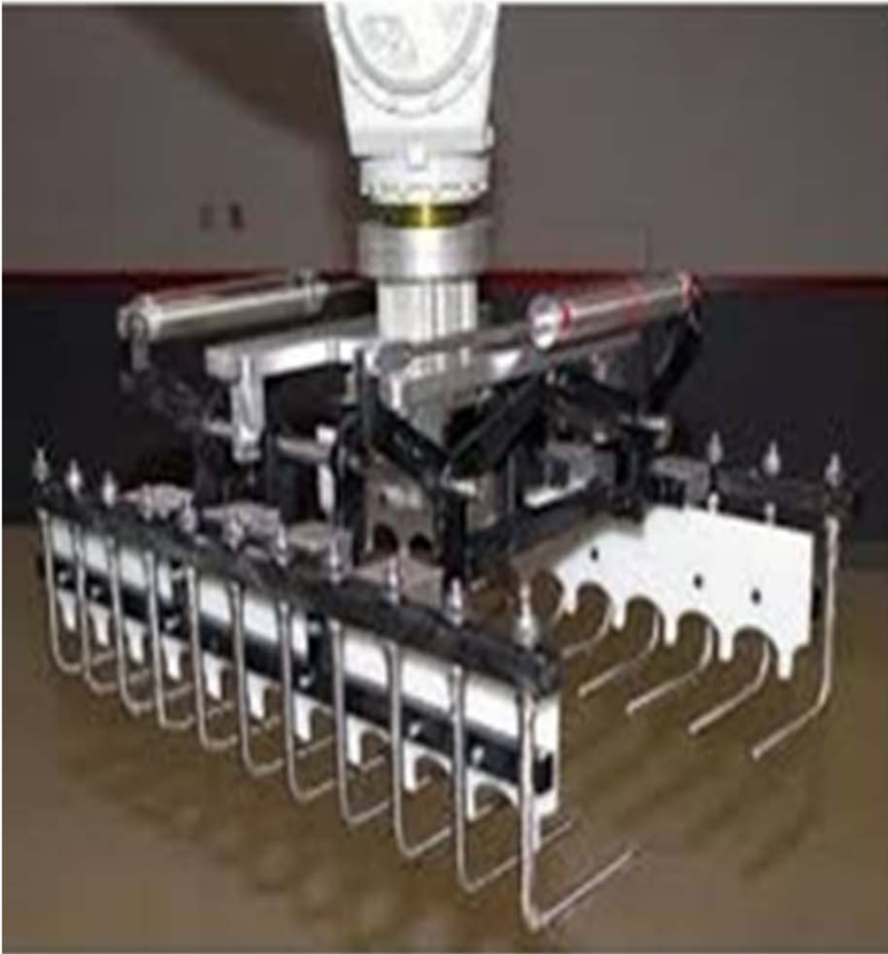
Рисунок 1.5 – Приклади робочих органів: захватні пристрої (а), зварювальні кліщі (б)
