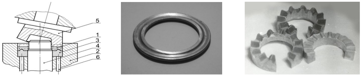
Рис. 5.5. Схема прямого витискування-калібрування і вигляд отриманих заготовок: 1 - заготовка, 2 - обойма, 3 - матриця, 4 - оправка, 5 - валок, 6- виштовхувач
