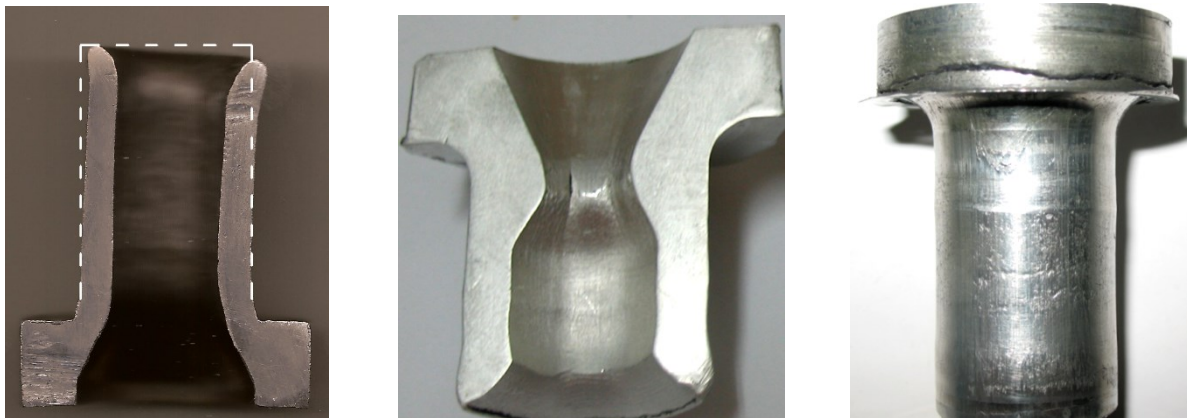
Рис. 1.21. Дефекти у вигляді викривлення відростка і складок у процесі радіально-прямого видавлювання з обтисненням
