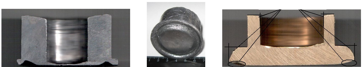
Рис. 1.21. Дефекти у вигляді викривлення відростка і складок у процесі радіально-прямого видавлювання з обтисненням
