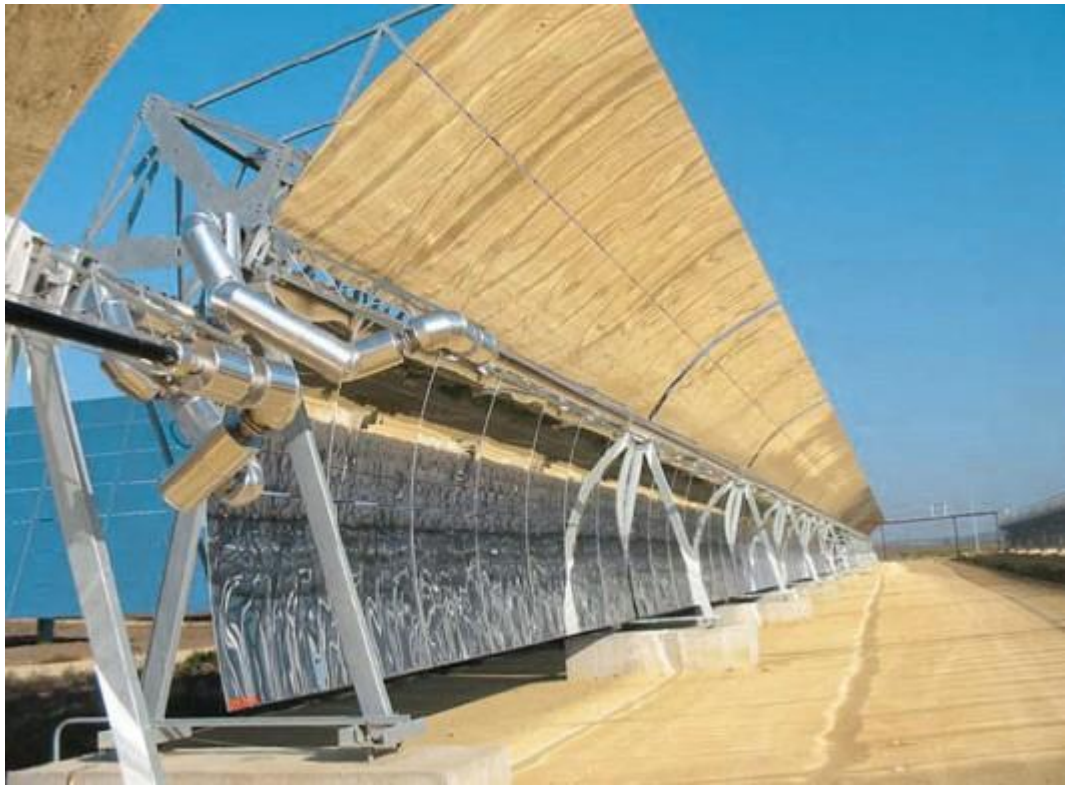
Рис. 1.8. Довгі параболічні (в поперечному перерізі) дзеркала з трубами для розігрівання теплоносія (фото «Solucar»)
