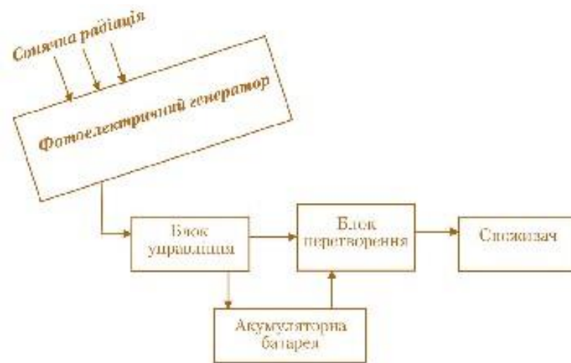
Рис. 1.12. Блок-схема сонячної фотоелектричної станції
