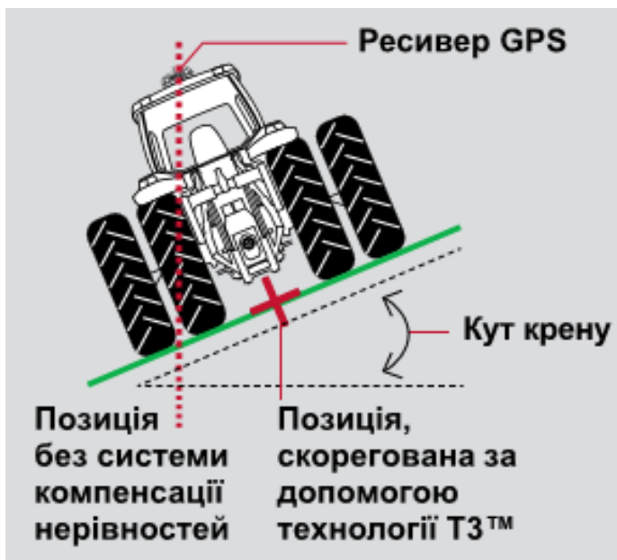
Рис. Схеми визначення кута нахилу та компенсації нерівностей місцевості
