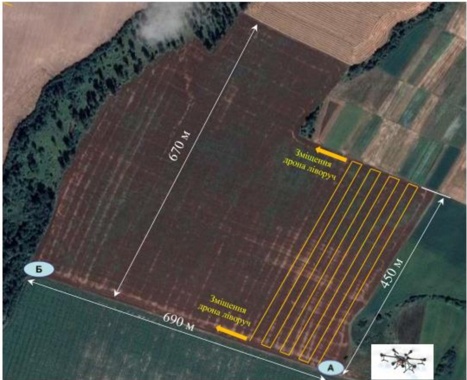
Рис. Схема робочої ділянки для визначення продуктивності Agras T16
