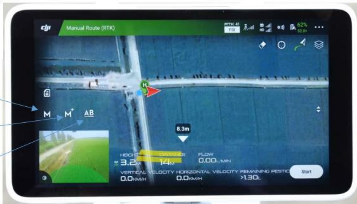
Рис. Відображення режимів роботи на пульту дистанційного керування Agras T16
