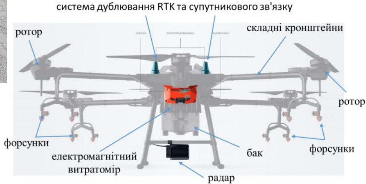
Рис. Схема розташування основних елементів Agras T16
