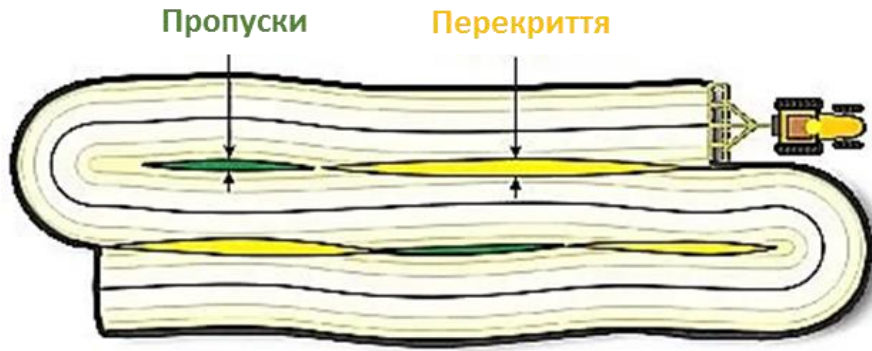
Рис. Схема утворення пропусків та перекриттів на прикладі операції посіву
