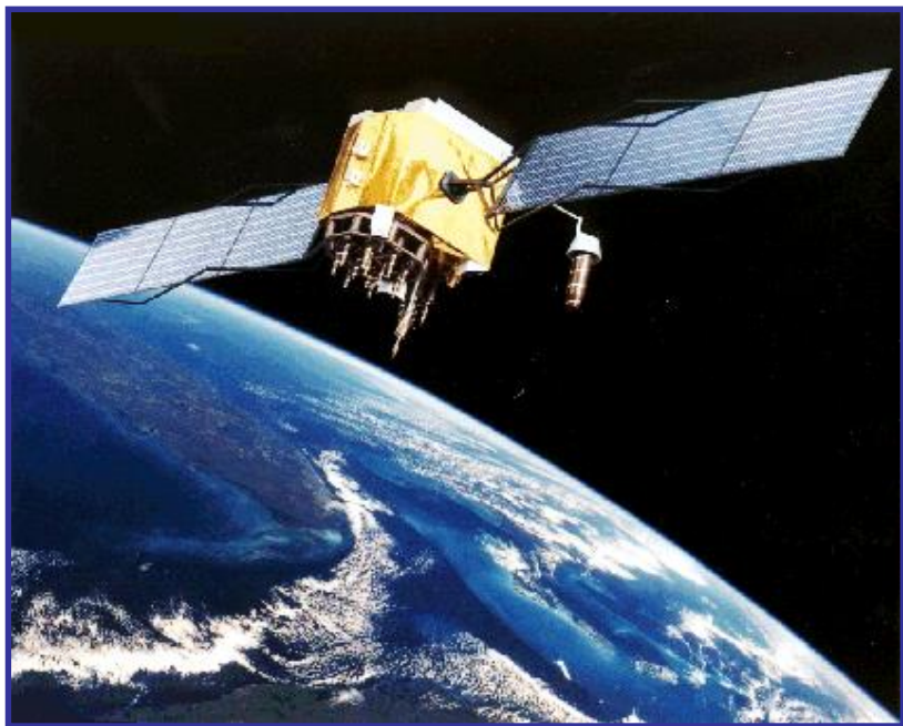
Рис. Видял супутника NAVSTAR, що використовується для GPS-навігації
