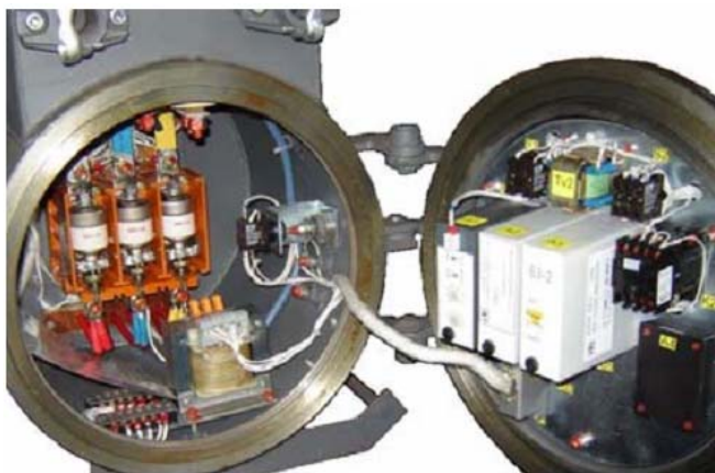
Мал. 3.5. Вакуумний контактор та допоміжні апарати у вибухозахисній оболонці
