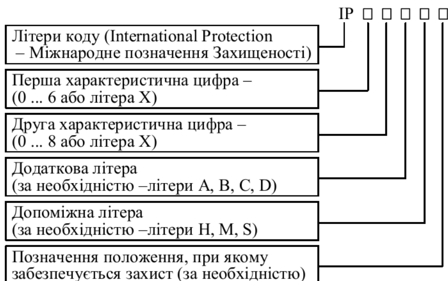
Мал. 2.29. Структура коду IP (літеру X записують, якщо нема необхідності нормувати характеристичну цифру)
