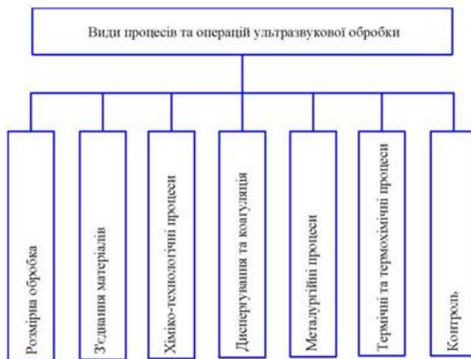
Рисунок 4.9. – Класифікація процесів та операцій ультразвукової обробки
